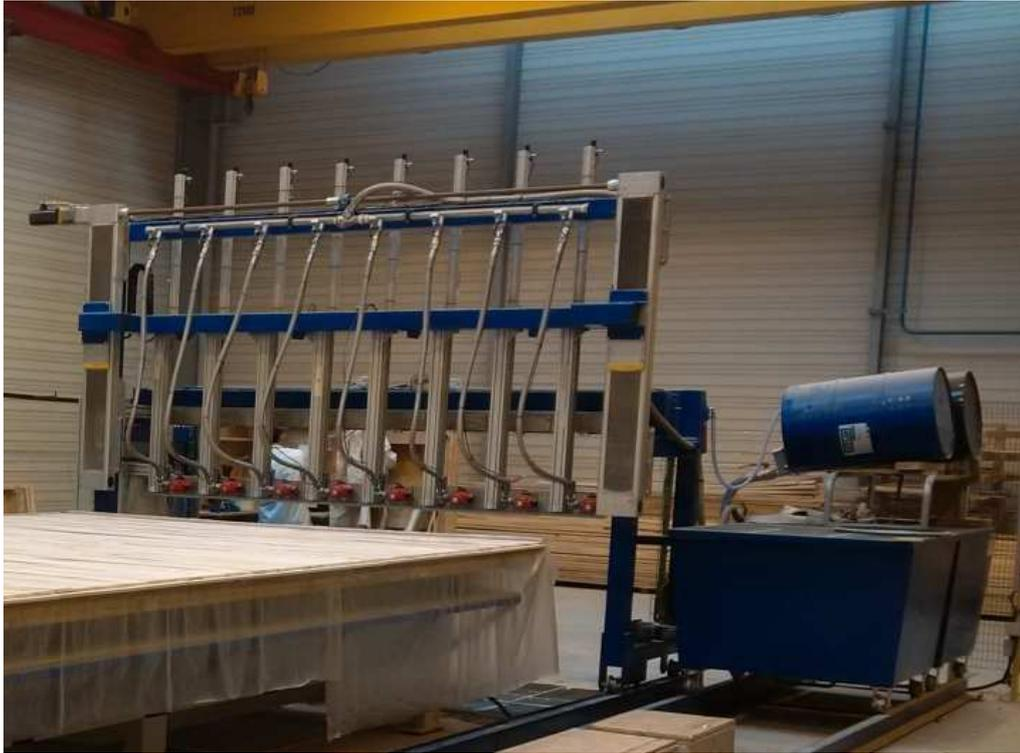
Les plis de lames sont ensuite positionnés et encollés. Après le passage de l'encolleuse, on reconstitue un deuxième pli, et ainsi de suite. L'encolleuse est montée sur un portique 3 axes, pilotée par une commande numérique couplée à la presse hydraulique. Elle permet d'assurer un encollage de chaque pli de panneau CLT en moins de 2 minutes et de garantir un dosage uniforme et précis de la colle.
